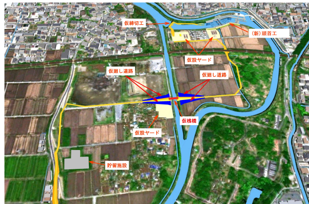
図-2 関係者説明に活用した仮設モデル Fig-2 Temporary construction model used for explanations to stakeholders
